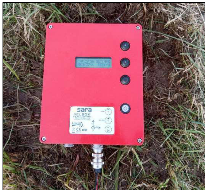
Figura 4 – Strumentazione utilizzata – Registratore sismico SL06
