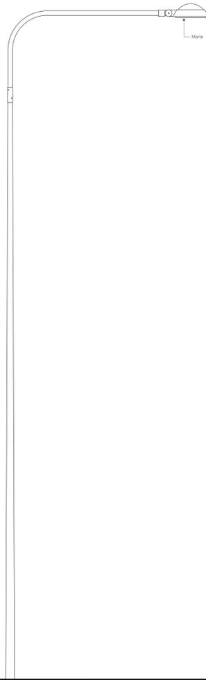
PARTICOLARE PALO IN CEMENTO CON BRACCIO ED ARMATURA MARTE
